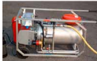
Unit voor het verwarmen van het gereinigde water.
